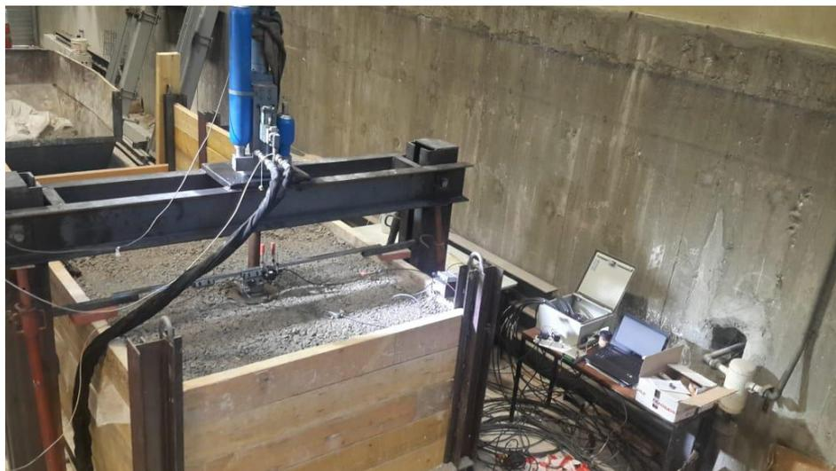
Figure 1. Illustration des essais sur plaque
